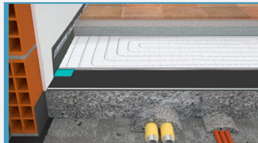
STRUTTURA CON RISCALDAMENTO A PAVIMENTO
