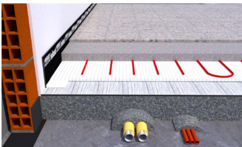
↑ *Isolmant UnderPlus Black.E è la versione specifica per le strutture con massetto tra 3 e 5 cm.*
